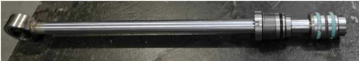
Resim 5.6. Silindir mil ve başlık kompleksinde kapak ve piston montajı
