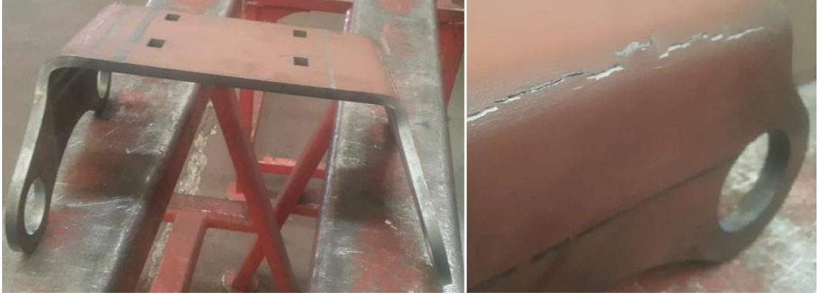
Şekil 3.15. Aşınmaya dayanıklı sac ile “U” büküm denemesi
