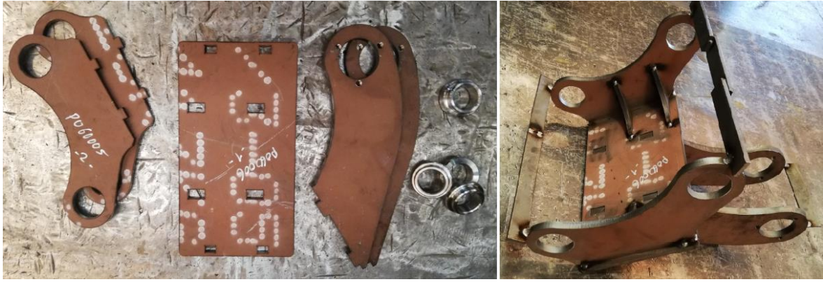
Resim 5.1. Bağlantı elemanı parçaları ve kaynak çatımı
