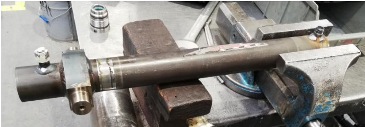
Resim 5.4. Silindir borusu, bağlantı sacı ve nipellerin kaynaktan sonra honlanmış ve işlenmiş montaja hazır hali
