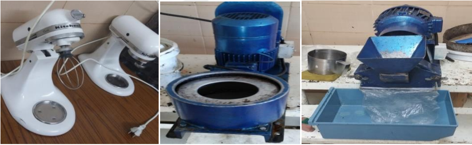
Şekil 3.2. 2016 Yılında zeytinyağı örneklerinin hazırlanmasında kullanılan karıştırıcı, santrifüj cihazı ve kırıcı
