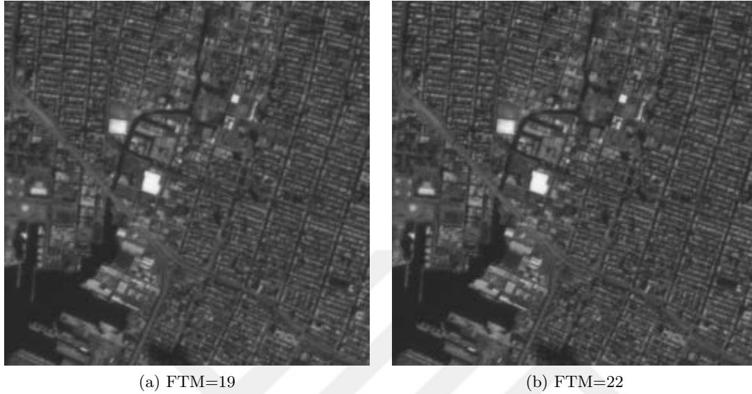
FIGURE 5.11 – Portion de New York (250x250) pour deux valeurs de FTM proches : FTM=19 (a) et FTM=22 (b).
