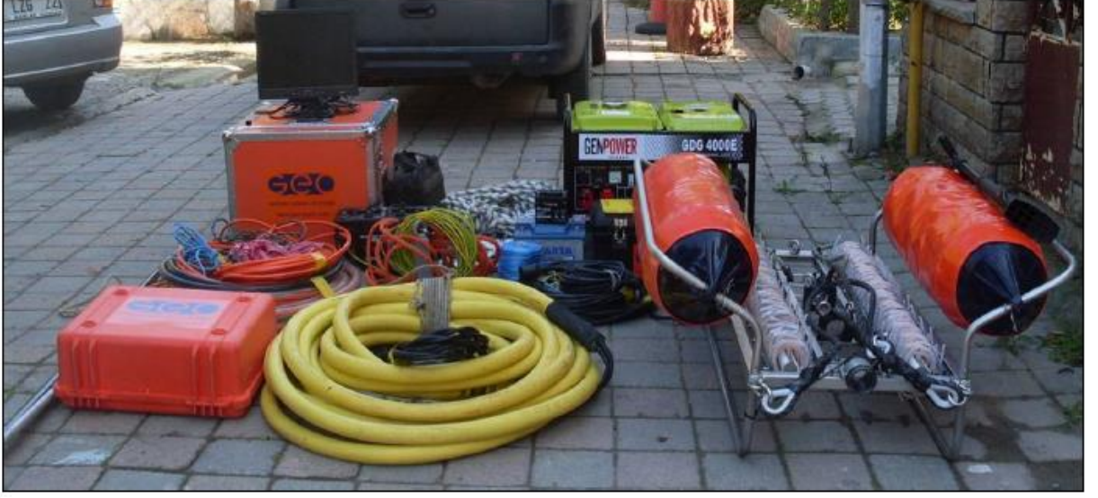
Şekil 3.55: Sismik yansıma verisinin toplanmasında kullanılan ekipmanlar.
