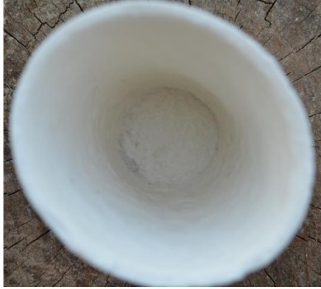
Resim 35. 1250 °C pişirilmiş deneme deformasyon testi (üst görünüm)
