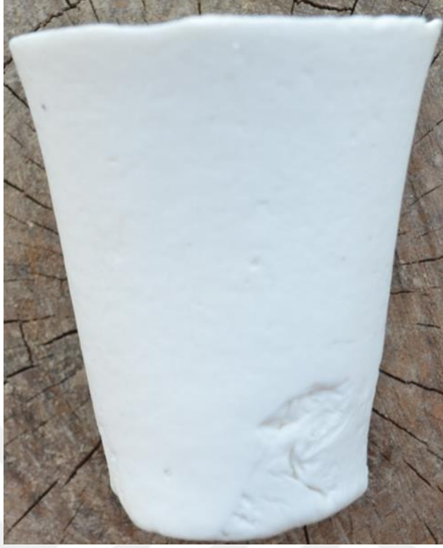
Resim 34. 1250 °C pişirilmiş deneme deformasyon testi
