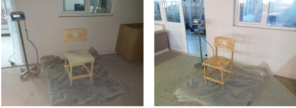
Şekil 4. 3. Deney sandalyelerinin ağırlıklarının hassas kantar ile ölçülmesi
