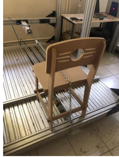
Şekil 3. 22. Arkadan öne yükleme performans testi
