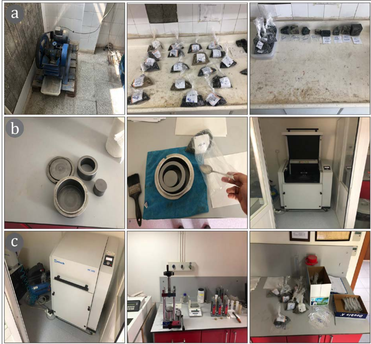
Şekil 3.4. RS200 ve Kırıcı ile; a: Kırma, b ve c: Öğütme aşamaları.
