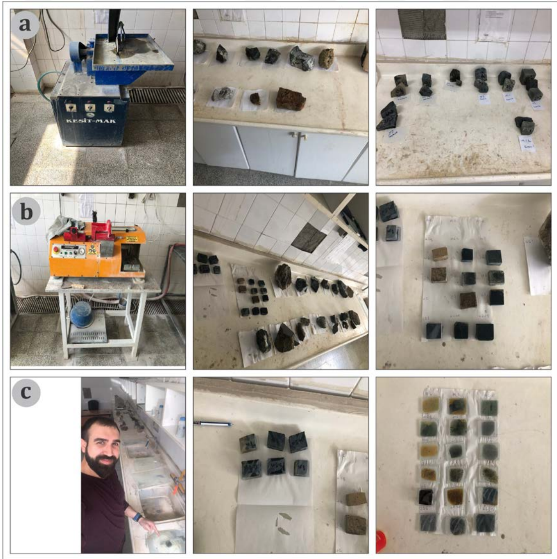
Şekil 3.2. İnce kesit yapım aşamaları: a, b) kesme, c) yapıştırma ve inceltme.
