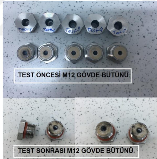
Şekil 4.14. Kapalı Bomba Testinde Kullanılan M12 Gövde Bütünü
