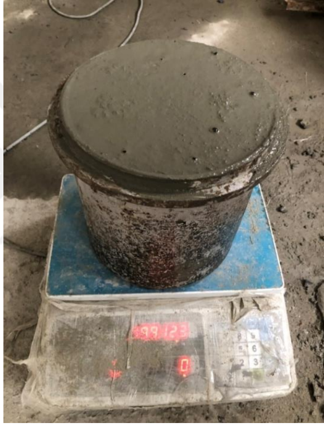
Şekil 3.3: Birim ağırlık deney uygulaması
