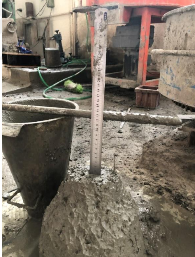
Şekil 3.2: Çökme deneyi uygulaması.
