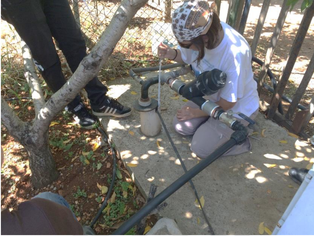
Şekil 3.2. Arazide yeraltısuyu kotu ölçümleri.
