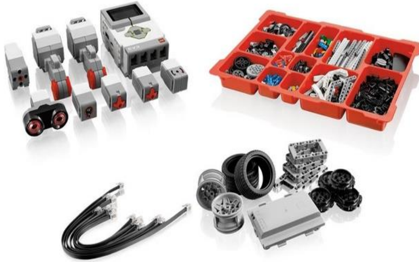
Resim 2.1 Lego Mindstorms robotunun parçaları
