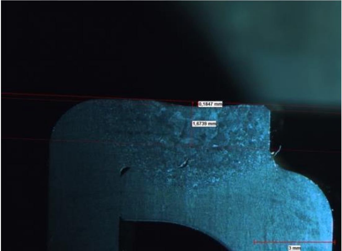
Şekil 5.15 Kupon 8 kesiti makro görüntü (KN: 1.67, KYÇ: 0.18) / Kaynak bölgesi 2
