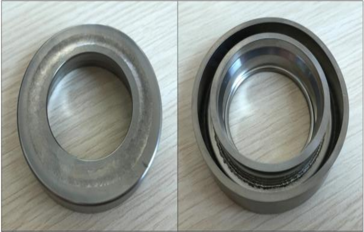
Şekil 5.36 Tam nüfuziyetli alın kaynaklı 2.5 mm kaynak arayüzü cidar kalınlığına sahip Şekil 5.35 de temel ölçüleri belirtilen kuponun görüntüsü
