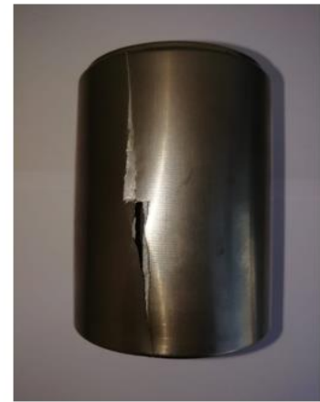
Şekil 5.23 1 numaralı basınçlı tüpün patlama basıncı-zaman grafiği ve prototip
