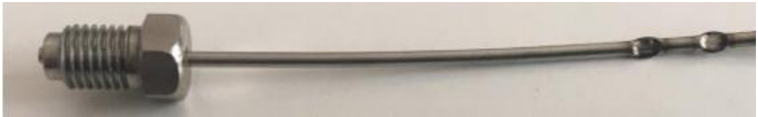
Şekil 4.1 1/16” lik kılcal borunun punta kaynağına ait görüntü
