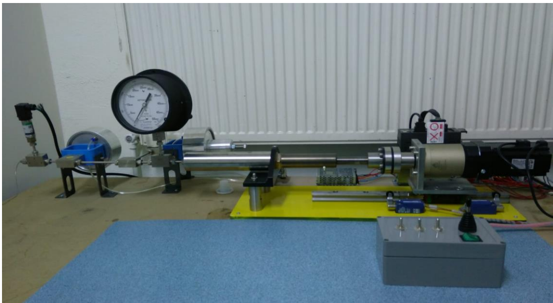
Şekil 4.3 Su ile patlatma test düzeneği fotoğrafı
