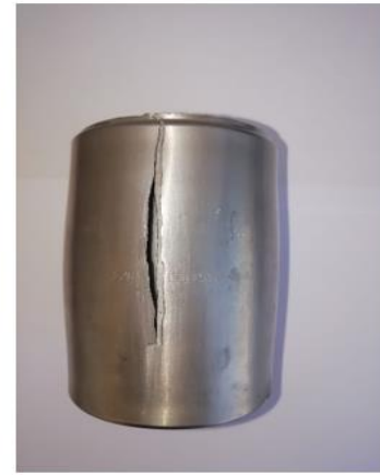
Şekil 5.28 6 numaralı basınçlı tüpün patlama basıncı-zaman grafiği ve prototip
