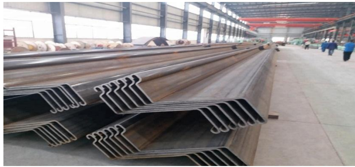
řekil 2. 15. Z tipi palplanř (Alkaya, 2010)
