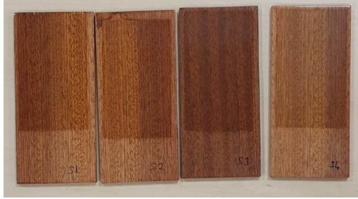
Şekil 4.35: “S” marka poliüretan vernik uygulanmış sapelli ahşaplarının 500 saat yaşlandırma testi sonundaki görüntüsü.
