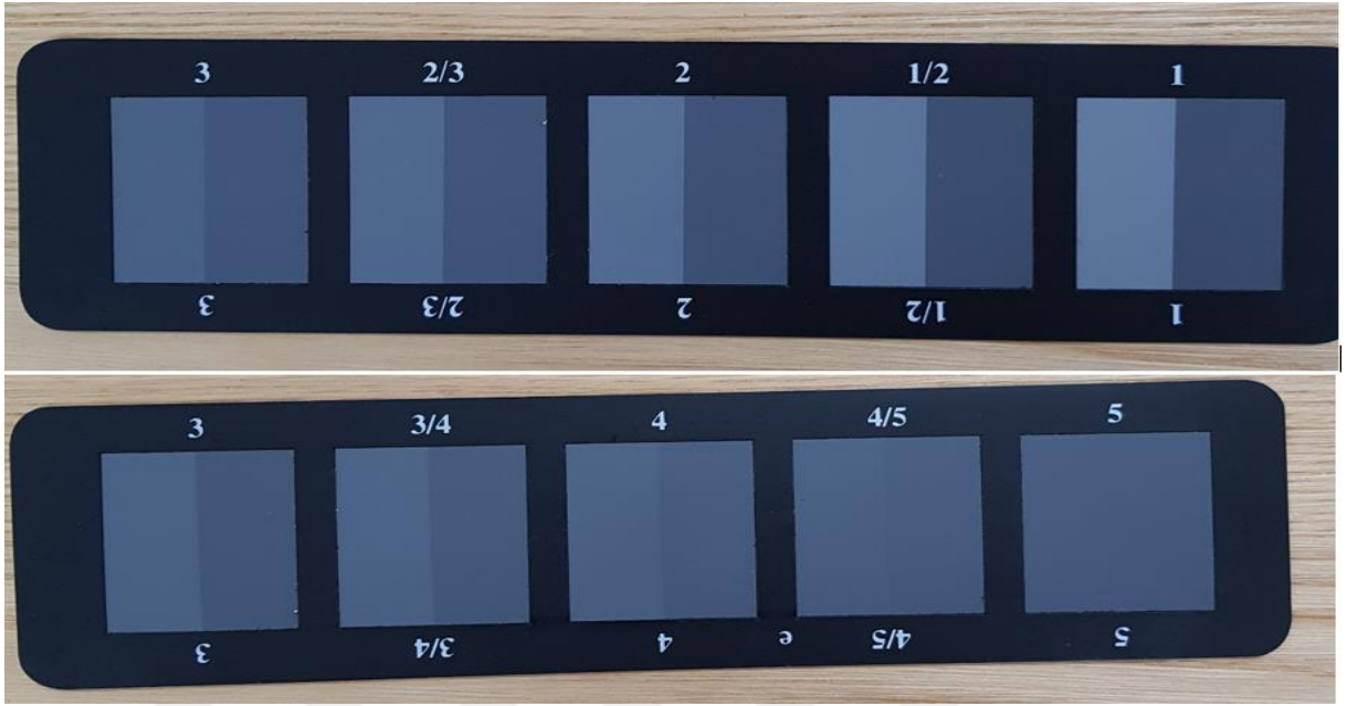
Şekil 3.21: Koyu renklerin gri skala değerlendirilmesinde orijinaline göre solmasının görsel değerlendirilmesi (EN 20105-A02).
