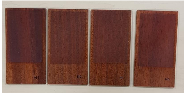
Şekil 4.46: “H” marka poliüretan vernik uygulanmış sapelli ahşaplarının görüntüsü.
