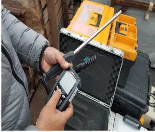
Şekil 3.17: KIMO/HD 200 nem ölçer cihazına ait bir görünüm.
