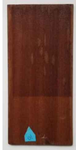
Şekil 4.81: “Ü” marka su bazlı vernik uygulanmış sapelli ahşaplarının 727 saat yaşlandırma testi sonundaki görüntüsü.
