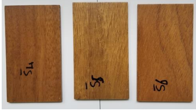
Şekil 4.66: “S” marka su bazlı vernik uygulanmış dabema ahşaplarının görüntüsü.
