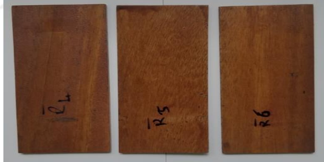
Şekil 4.70: “R” marka su bazlı vernik uygulanmış dabema ahşaplarının görüntüsü.
