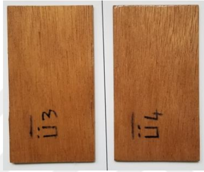
Şekil 4.61: “Ü” marka poliüretan vernik uygulanmış dabema ahşaplarının görüntüsü.
