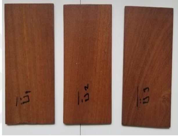
Şekil 4.80: “Ü” marka su bazlı vernik uygulanmış sapelli ahşaplarının görüntüsü.
