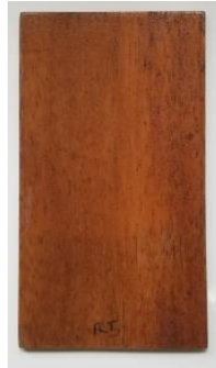
Şekil 4.71: “R” marka su bazlı vernik uygulanmış dabema ahşaplarının 727 saat yaşlandırma testi sonundaki görüntüsü.
