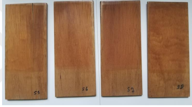
Şekil 4.39: “S” marka poliüretan vernik uygulanmış dabema ahşaplarının 727 saat yaşlandırma testi sonundaki görüntüsü.
