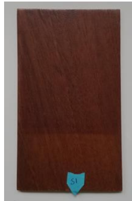
Şekil 4.65: “S” marka su bazlı vernik uygulanmış sapelli ahşaplarının 727 saat yaşlandırma testi sonundaki görüntüsü.
