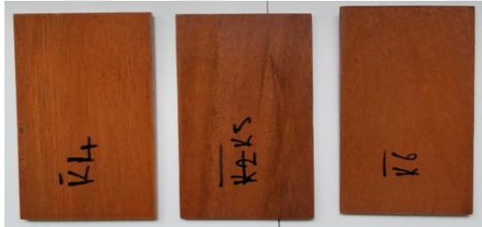
Şekil 4.77: “K” marka su bazlı vernik uygulanmış sapelli ahşaplarının 727 saat yaşlandırma testi sonundaki görüntüsü.
