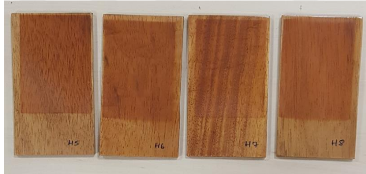
Şekil 4.49: “H” marka poliüretan vernik uygulanmış dabema ahşaplarının görüntüsü.
