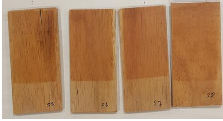
Şekil 4.38: “S” marka poliüretan vernik uygulanmış dabema ahşaplarının 500 saat yaşlandırma testi sonundaki görüntüsü.
