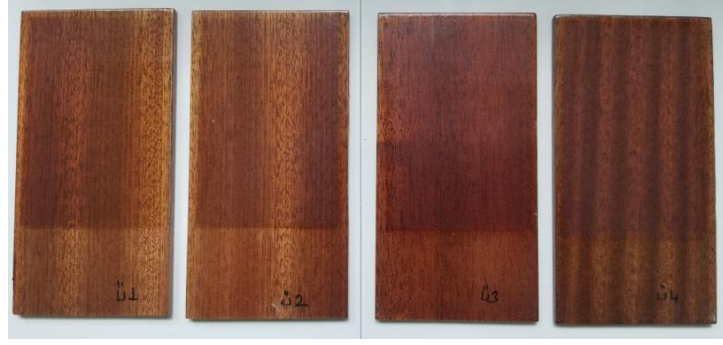
Şekil 4.60: “Ü” marka poliüretan vernik uygulanmış sapelli ahşaplarının 727 saat yaşlandırma testi sonundaki görüntüsü.
