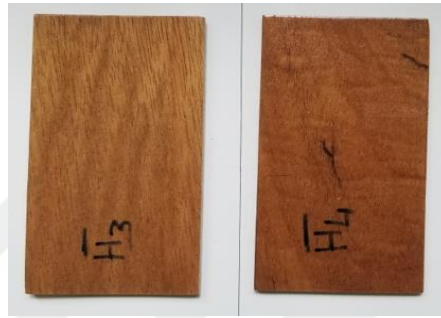
Şekil 4.49: “H” marka poliüretan vernik uygulanmış dabema ahşaplarının görüntüsü.
