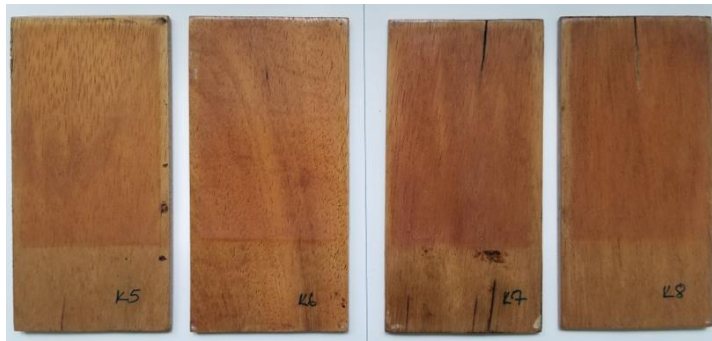
Şekil 4.57: “K” marka poliüretan vernik uygulanmış dabema ahşaplarının 727 saat yaşlandırma testi sonundaki görüntüsü.
