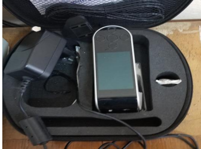
Şekil 3.27: Gloss metre yüzey parlaklık ölçüm cihazına ait bir görünüm.
