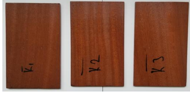
Şekil 4.76: “K” marka su bazlı vernik uygulanmış sapelli ahşaplarının görüntüsü.
