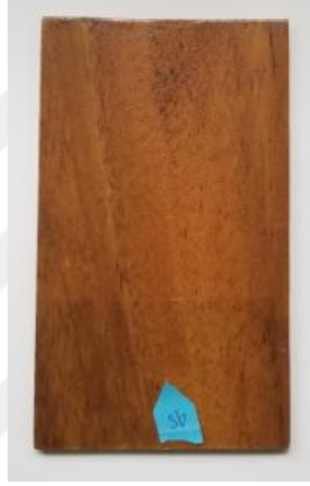
Şekil 4.67: “S” marka su bazlı vernik uygulanmış dabema ahşaplarının 727 saat yaşlandırma testi sonundaki görüntüsü.
