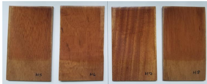
Şekil 4.50: “H” marka poliüretan vernik uygulanmış dabema ahşaplarının 500 saat yaşlandırma testi sonundaki görüntüsü.
