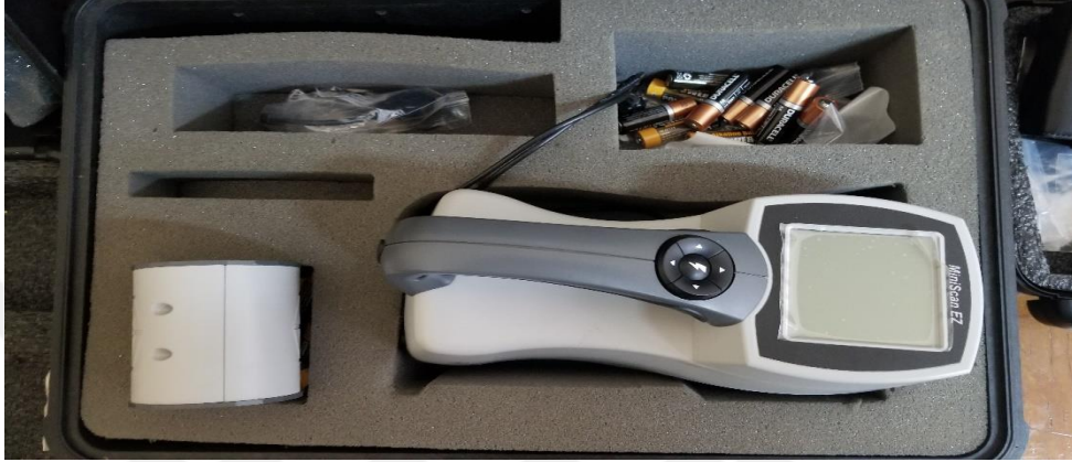
Şekil 3.29: Hunterlab Miniscan EZ renk ölçüm test cihazına ait bir görünüm.
