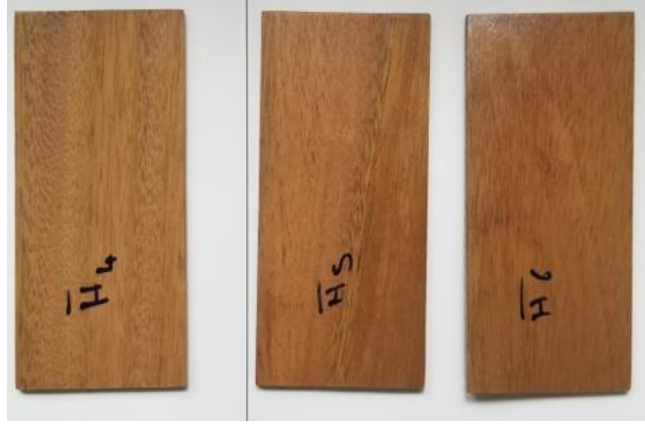
Şekil 4.74: “H” marka su bazlı vernik uygulanmış dabema ahşaplarının görüntüsü.
