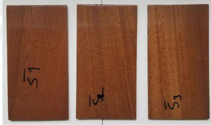
Şekil 4.64: “S” marka su bazlı vernik uygulanmış sapelli ahşaplarının görüntüsü.
