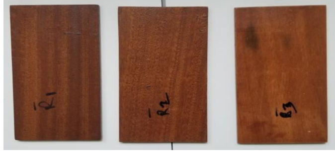
Şekil 4.68: “R” marka su bazlı vernik uygulanmış sapelli ahşaplarının görüntüsü.
