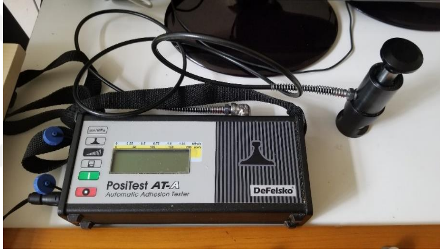
Şekil 3.23: Positest-AT yapışma testi uygulamaları test cihazına ait bir görünüm.
