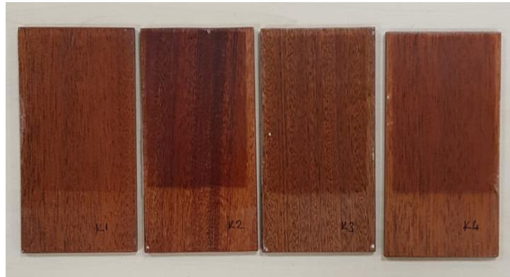
Şekil 4.53: “K” marka poliüretan vernik uygulanmış sapelli ahşaplarının 500 saat yaşlandırma testi sonundaki görüntüsü.
