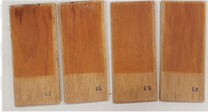
Şekil 4.43: “R” marka poliüretan vernik uygulanmış dabema ahşaplarının görüntüsü.
