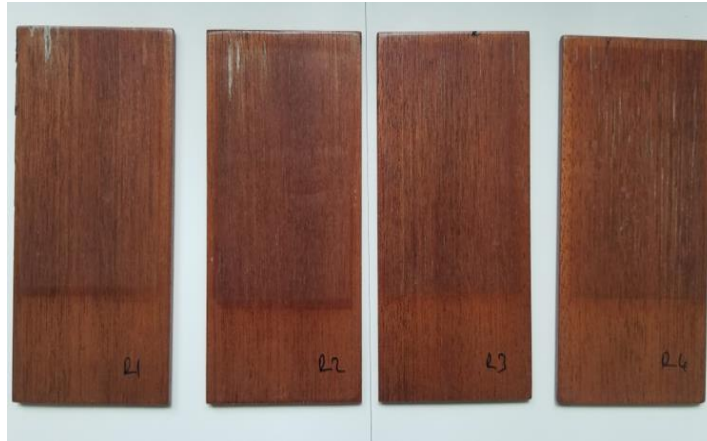
Şekil 4.41: “R” marka poliüretan vernik uygulanmış sapelli ahşaplarının 500 saat yaşlandırma testi sonundaki görüntüsü.
