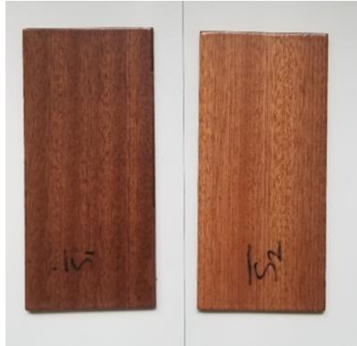
Şekil 4.34: “S” marka poliüretan vernik uygulanmış sapelli ahşaplarının görüntüsü.
