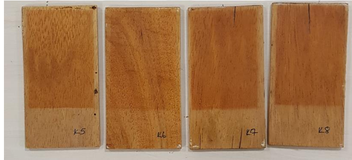
Şekil 4.56: “K” marka poliüretan vernik uygulanmış dabema ahşaplarının 500 saat yaşlandırma testi sonundaki görüntüsü.
