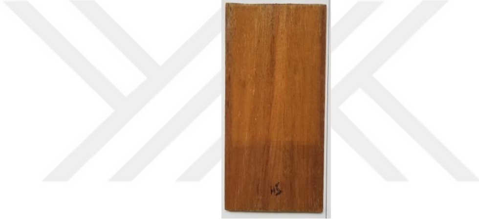
Şekil 4.75: “H” marka su bazlı vernik uygulanmış dabema ahşaplarının 727 saat yaşlandırma testi sonundaki görüntüsü.
