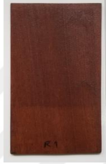
Şekil 4.68: “R” marka su bazlı vernik uygulanmış sapelli ahşaplarının görüntüsü.
