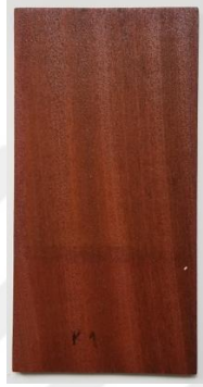
Şekil 4.77: “K” marka su bazlı vernik uygulanmış sapelli ahşaplarının 727 saat yaşlandırma testi sonundaki görüntüsü.
