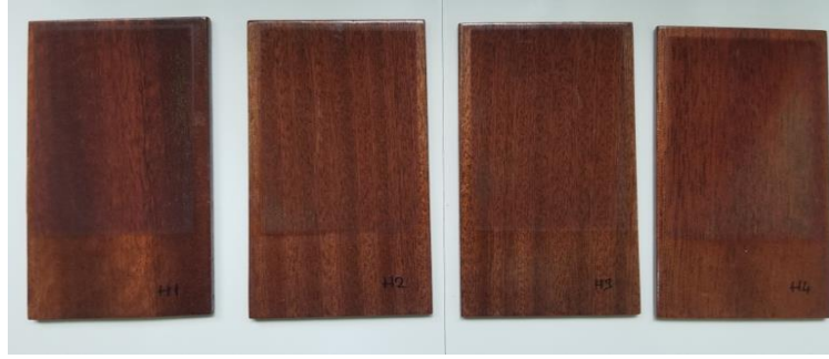
Şekil 4.48: “H” marka poliüretan vernik uygulanmış sapelli ahşaplarının 727 saat yaşlandırma testi sonundaki görüntüsü.
