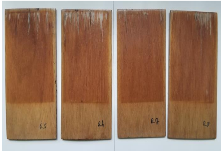
Şekil 4.44: “R” marka poliüretan vernik uygulanmış dabema ahşaplarının 500 saat yaşlandırma testi sonundaki görüntüsü.
