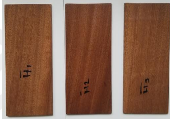
Şekil 4.72: “H” marka su bazlı vernik uygulanmış sapelli ahşaplarının görüntüsü.
