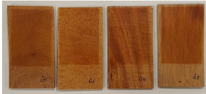
Şekil 4.62: “Ü” marka poliüretan vernik uygulanmış dabema ahşaplarının 500 saat yaşlandırma testi sonundaki görüntüsü.
