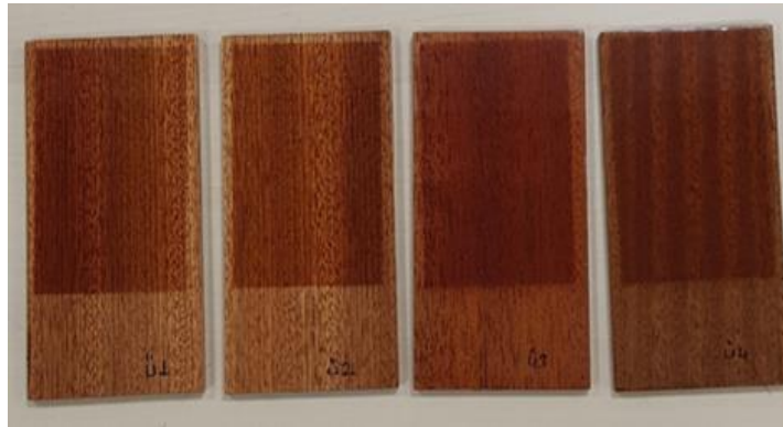
Şekil 4.59: “Ü” marka poliüretan vernik uygulanmış sapelli ahşaplarının 500 saat yaşlandırma testi sonundaki görüntüsü.
