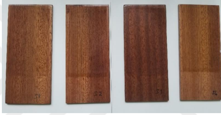
Şekil 4.36: “S” marka poliüretan vernik uygulanmış sapelli ahşaplarının 727 saat yaşlandırma testi sonundaki görüntüsü.
