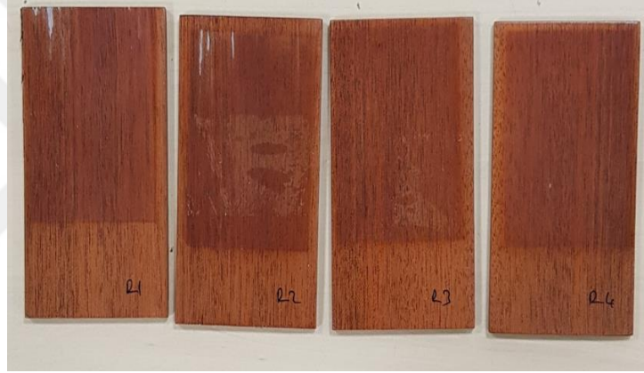
Şekil 4.40: “R” marka poliüretan vernik uygulanmış sapelli ahşaplarının görüntüsü.
