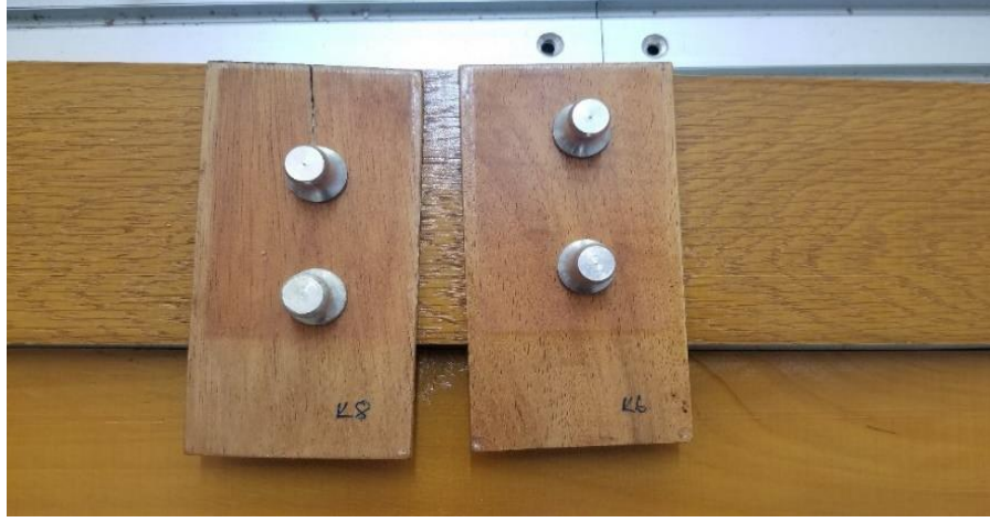
Şekil 3.22: Dolilerin ahşap numunelere yapıştırılması işlemine ait bir görünüm.
