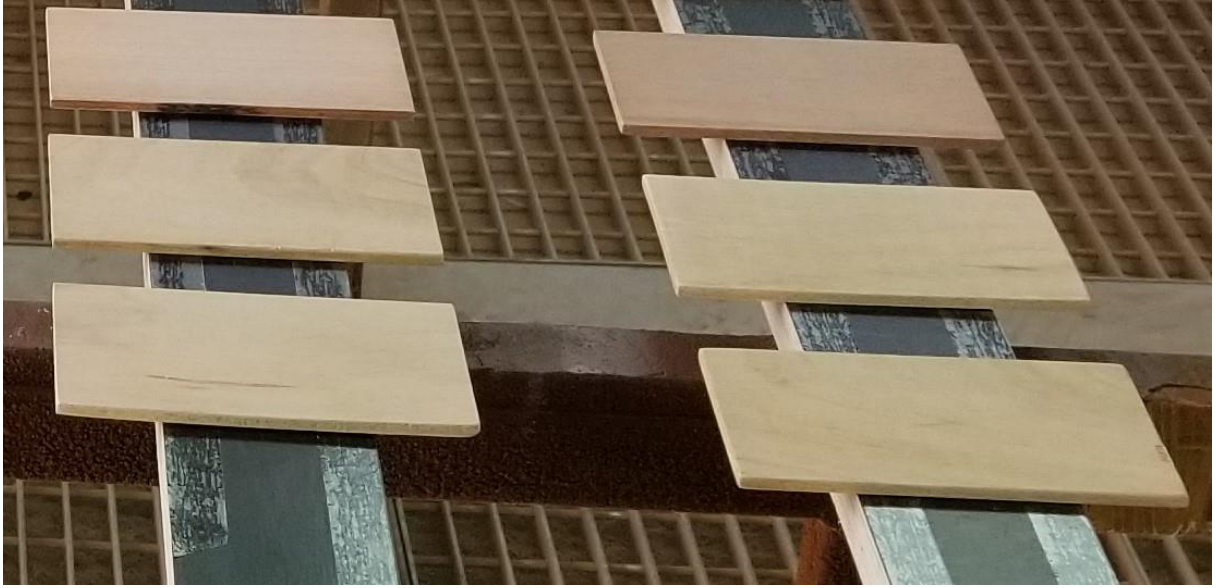
Şekil 3.7: 140*75*5 mm boyutlarına getirilmiş ahşap numunelere ait bir görünüm.
