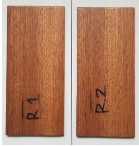
Şekil 4.40: “R” marka poliüretan vernik uygulanmış sapelli ahşaplarının görüntüsü.
