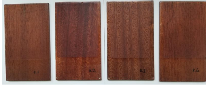
Şekil 4.54: “K” marka poliüretan vernik uygulanmış sapelli ahşaplarının 727 saat yaşlandırma testi sonundaki görüntüsü.
