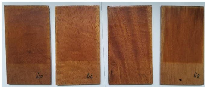
Şekil 4.63: “Ü” marka poliüretan vernik uygulanmış dabema ahşaplarının 727 saat yaşlandırma testi sonundaki görüntüsü.
