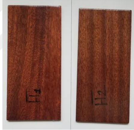
Şekil 4.46: “H” marka poliüretan vernik uygulanmış sapelli ahşaplarının görüntüsü.
