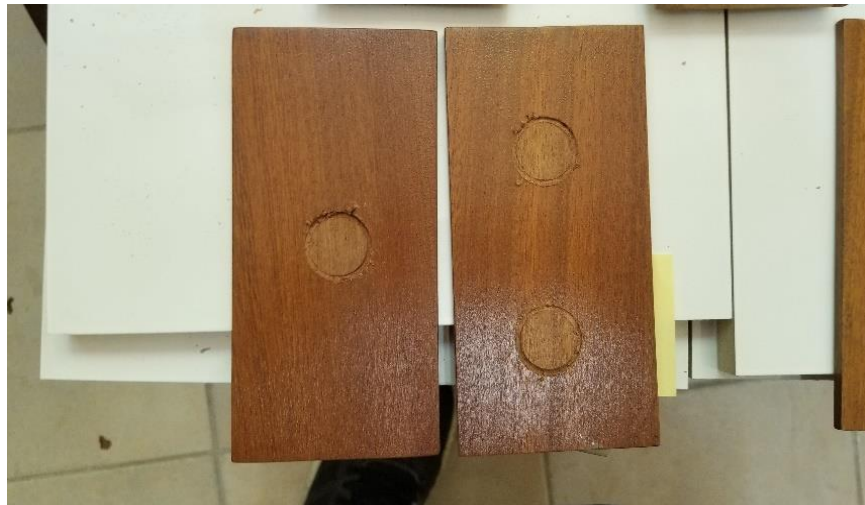
Şekil 3.23: Positest-AT yapışma testi uygulamaları test cihazına ait bir görünüm.
