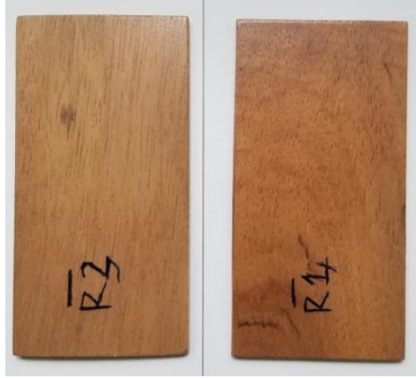
Şekil 4.43: “R” marka poliüretan vernik uygulanmış dabema ahşaplarının görüntüsü.
