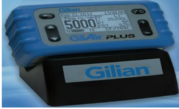
Şekil 3.10: Gilian-gilair plus marka düşük akışlı hava çekiş pompasına ait bir görünüm.
