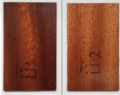
Şekil 4.58: “Ü” marka poliüretan vernik uygulanmış sapelli ahşaplarının görüntüsü.
