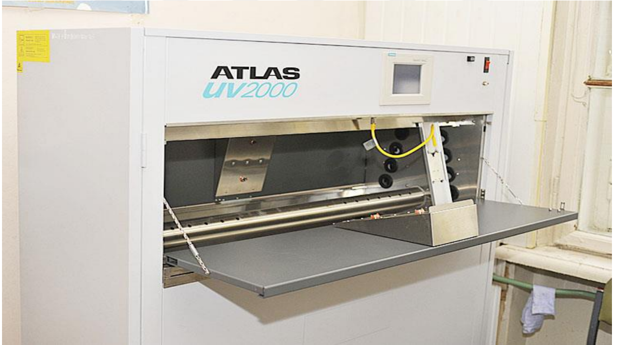
Şekil 3.18: ATLAS UV 2000 yaşlandırma test cihazına ait bir görünüm.
