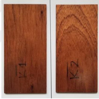
Şekil 4.52: “K” marka poliüretan vernik uygulanmış sapelli ahşaplarının görüntüsü.
