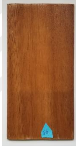
Şekil 4.83: “Ü” marka su bazlı vernik uygulanmış dabema ahşaplarının 727 saat yaşlandırma testi sonundaki görüntüsü.
