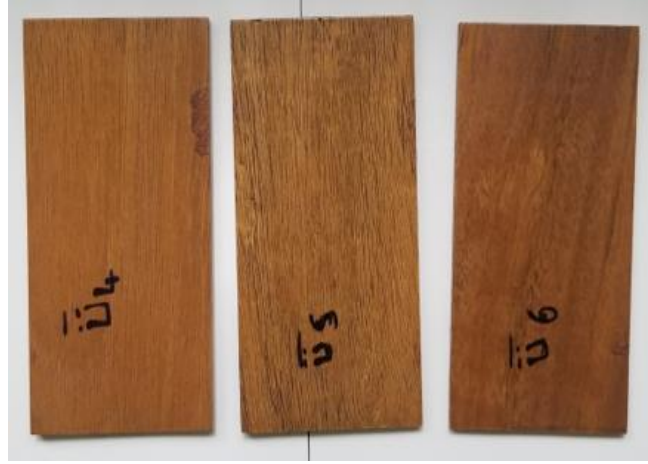
Şekil 4.82: “Ü” marka su bazlı vernik uygulanmış dabema ahşaplarının görüntüsü.
