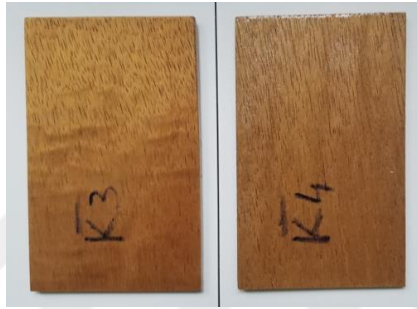
Şekil 4.55: “K” marka poliüretan vernik uygulanmış dabema ahşaplarının görüntüsü.
