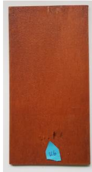
Şekil 4.79: “K” marka su bazlı vernik uygulanmış dabema ahşaplarının 727 saat yaşlandırma testi sonundaki görüntüsü.
