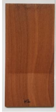
Şekil 4.72: “H” marka su bazlı vernik uygulanmış sapelli ahşaplarının görüntüsü.
