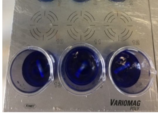
Şekil 8.1. MKEJ ile BM7 adsorpsiyonunda kullanılan kesikli sistem görüntüsü
