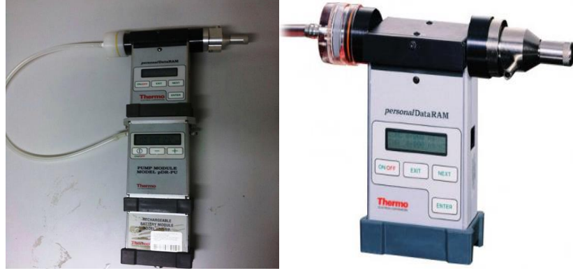
Şekil 3. 17: PM 2.5 ölçüm cihazı (pDR-1200).
