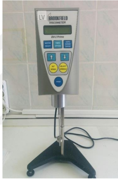
Şekil 2.3. Brookfield DVII prime rotasyon viskozimetresi
