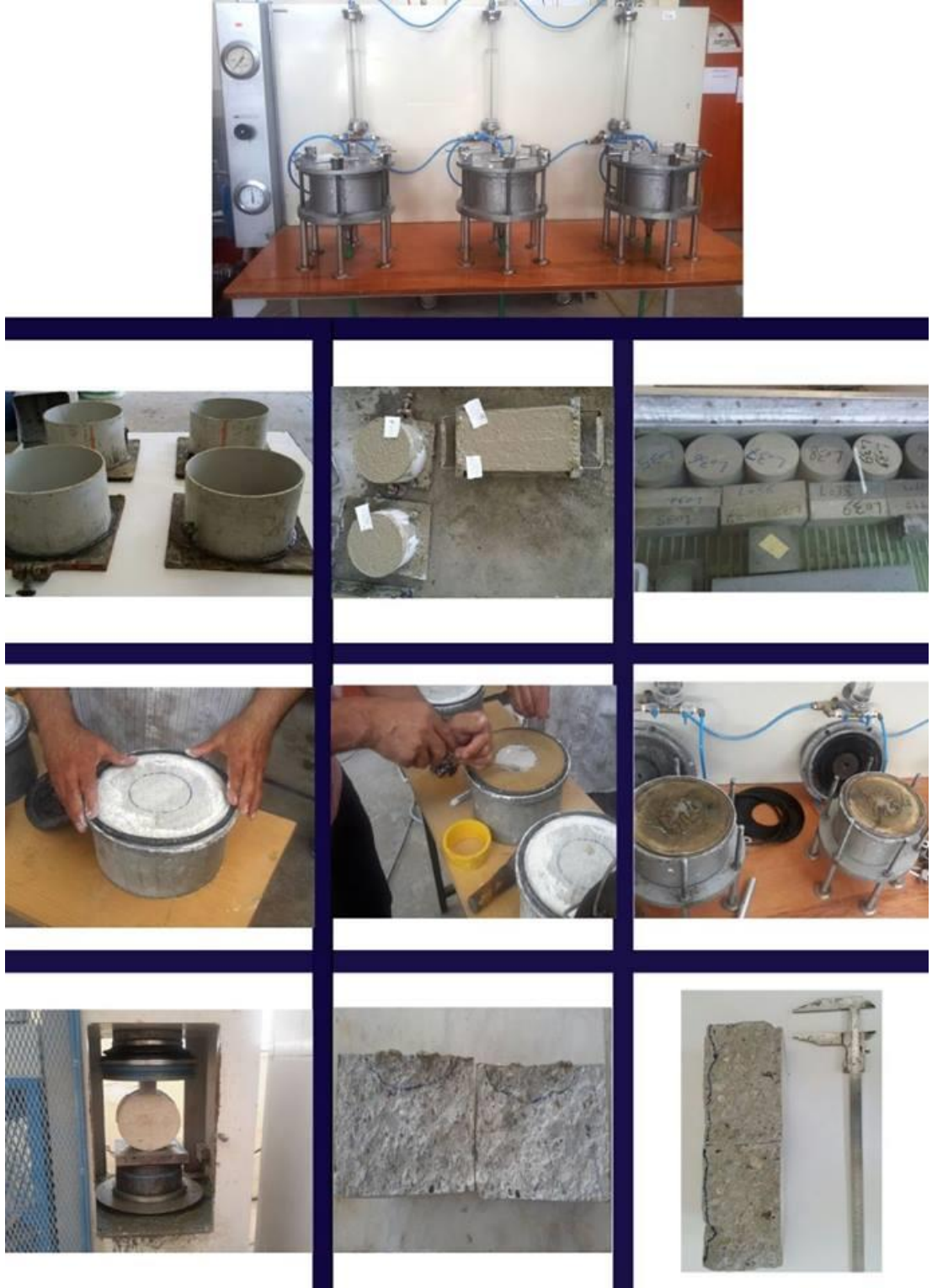
Şekil 4.29 Su geçirimsizlik deneyinde adım adım yaptıklarımız (Kişisel arşiv, 2013)
