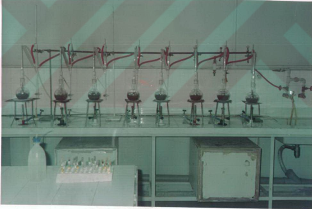
Resim 1: Origanum onites L. hatlarında uçucu yağ oranlarının su destilasyonu esasına göre Neo-clevenger apareyi ile saptanması (10.4.1991).
