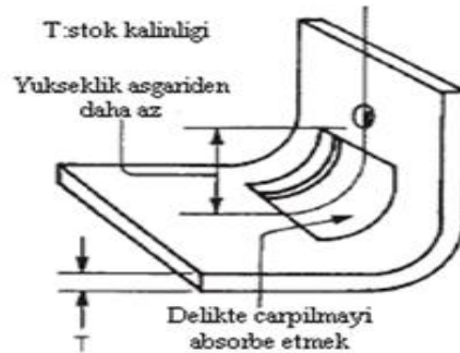
Şekil 5.10 Deliğin Bitişik yerleştirildiği büküm yuvarlağından dışarı çarpılması [40].
