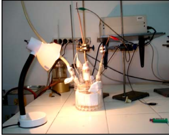
Fotoğraf 4.3 Işıklı - havasız (anaerob) ortam korozyon hücresi
