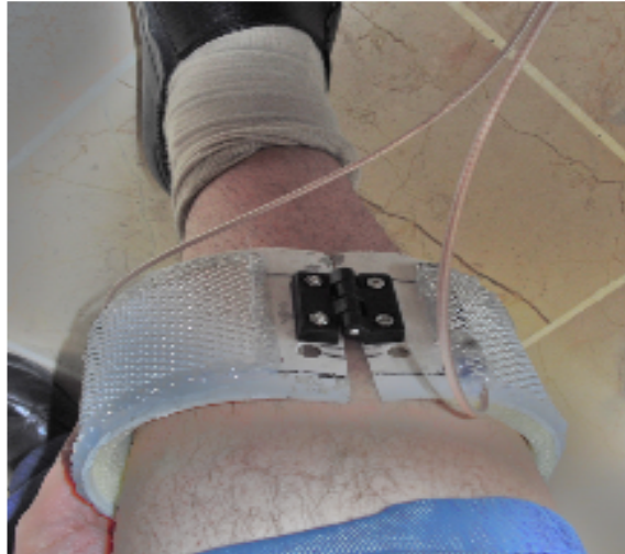
Şekil 5.3. Bileklik şeklinde ki sensörün hastaya uygulanması.
