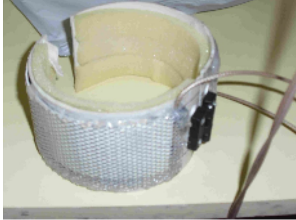
Şekil 4.2. Ölçüm sisteminde elektrotların yerleştirildiği sensör.
