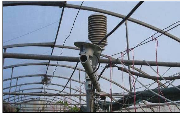
Şekil 3.5. Sera içinde bitki yüksekliğine göre ayarlanabilen iklim sensörleri.
