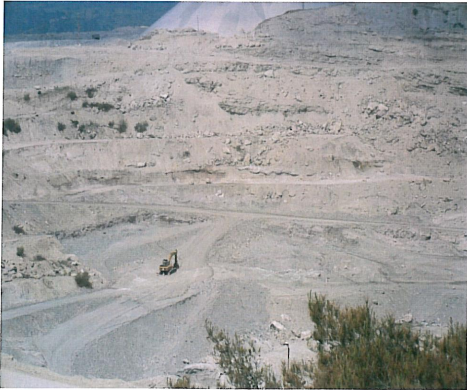
Resim 4. Açık işletme yöntemi ile borca fakir tabakanın traşlanması
