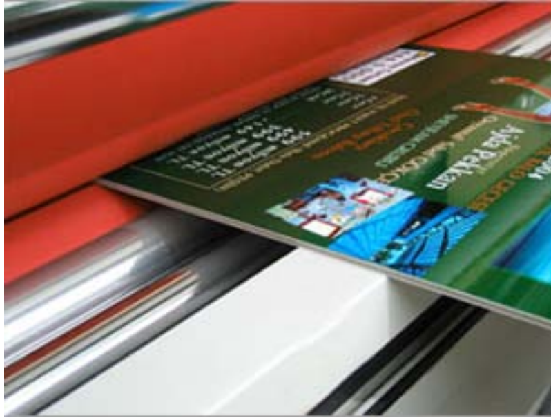
Görüntü 63: Dijital baskının fotoblok üzerine uygulanması. ( http://www.durakcopy.com.tr/durakimage/fotoblok.jpg )
