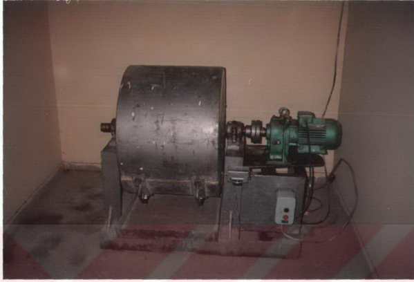
Şekil 3.3. Los Angeles aşınma makinasının genel görünüşü
