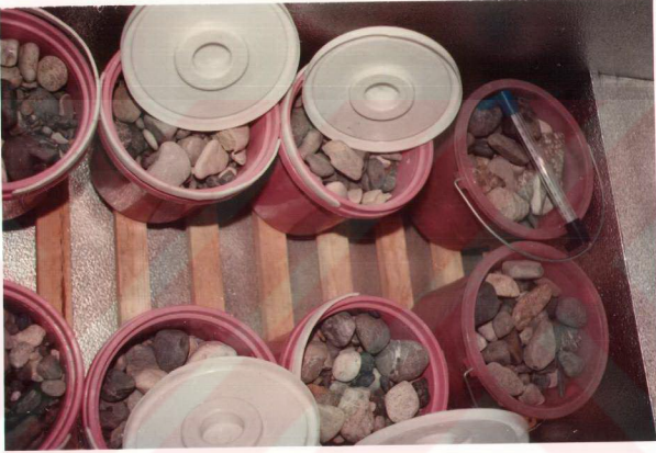
Şekil 3.8. Sodyum sülfat deneyinde kullanılan çözelti kapları
