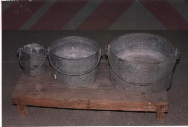
Şekil 3.5. Birim ağırlığın belirlenmesinde kullanılan ölçü kapları
