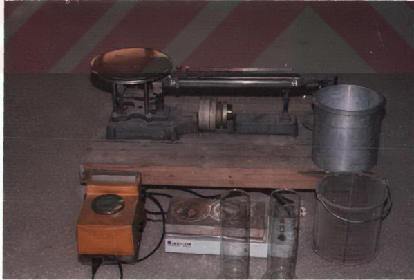
Şekil 3.4. Bağıl yoğunluk deneyinde kullanılan gereçler
