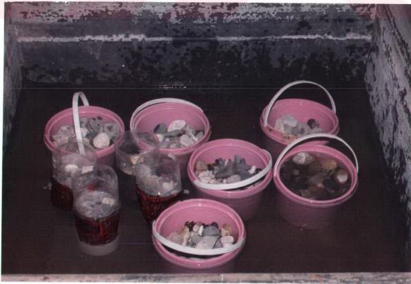
Şekil 3.11. Soğutucudan çıkarılan örneklerin çözümlerini sağlayan su tankı
