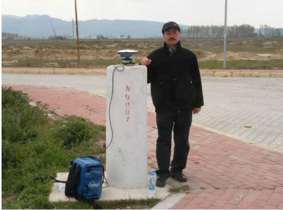
Resim 4. 3 Arazide yapılan Statik Ölçüm
