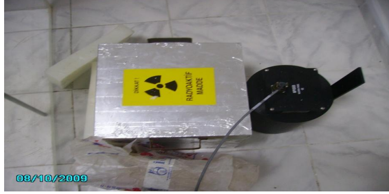
Şekil 3.11. Nötron Doz Transmisyon Ölçümü için Kullanılan Deney Geometrisi
