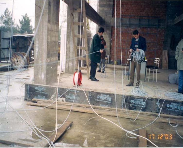
Şekil 4.4.c. Binaya ivmeölçerlerin yerleştirilme düzeni (3)
