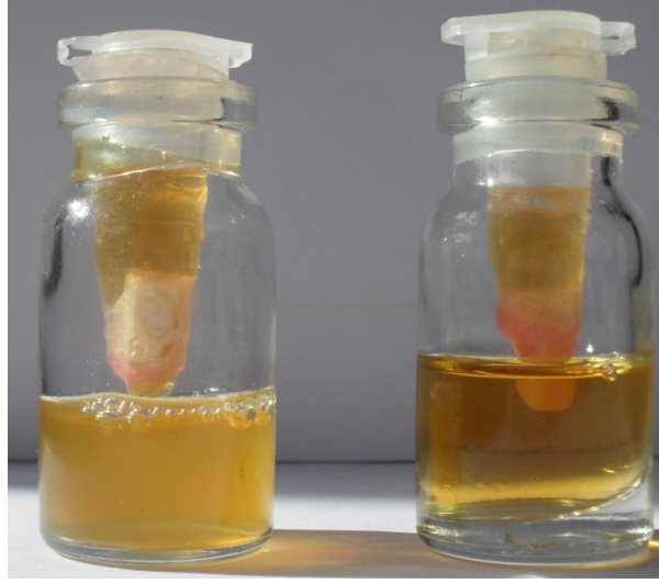
Şekil 2.5. Sızıntı görülen ve görülmeyen örnekler
