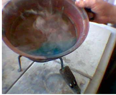
Şekil 40: Kurşun Kapta Çatının Asitte Kaynatılması
