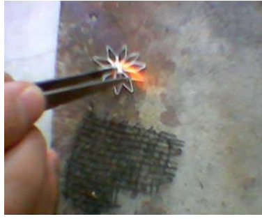
Şekil 39: Modele Kaynak Yapma
