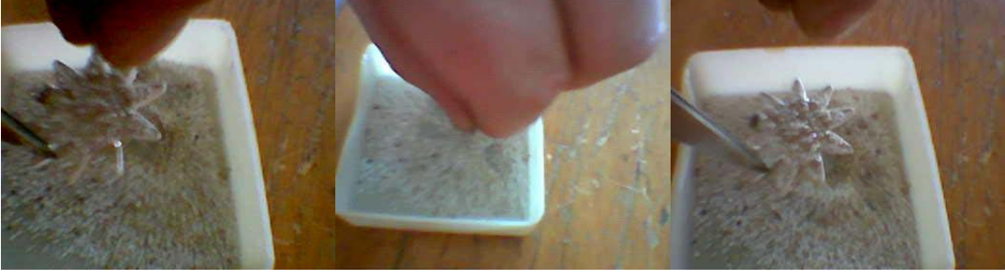
Şekil 44: Toz Kaynağın Serpilmesi
