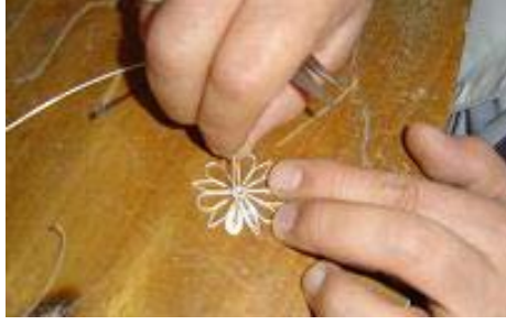
Şekil 42: Telkarinin Çatıya Göre Şekillendirilip Yerleştirilmesi
