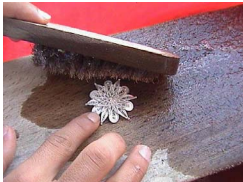
Şekil 52: Ağartma ve temizleme işlemi
