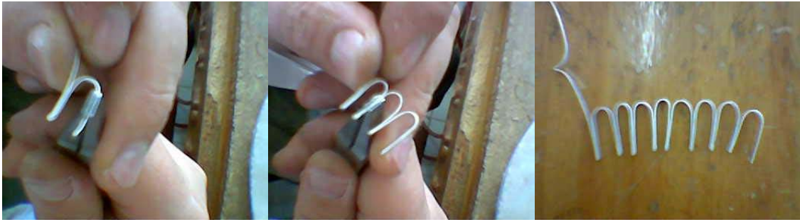
Şekil 35: Telin Teneke Kalıplara Sarılıp Çıkarılması
