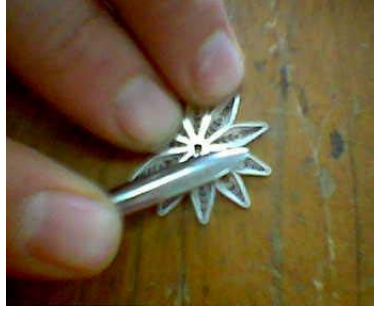
Şekil 48: Motifin Mazgal İle Parlatılması
