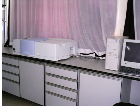
Şekil 8.4. Celal Bayar Üniversitesi Lüminesans Araştırma Laboratuvarında bulunan Perkin Elmer Lambda 950 UV/VIS/NIR Spektrofotometre Sistemi
