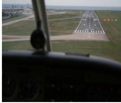
Şekil 24 Doğru açı ile inişi gösteren PAPI
