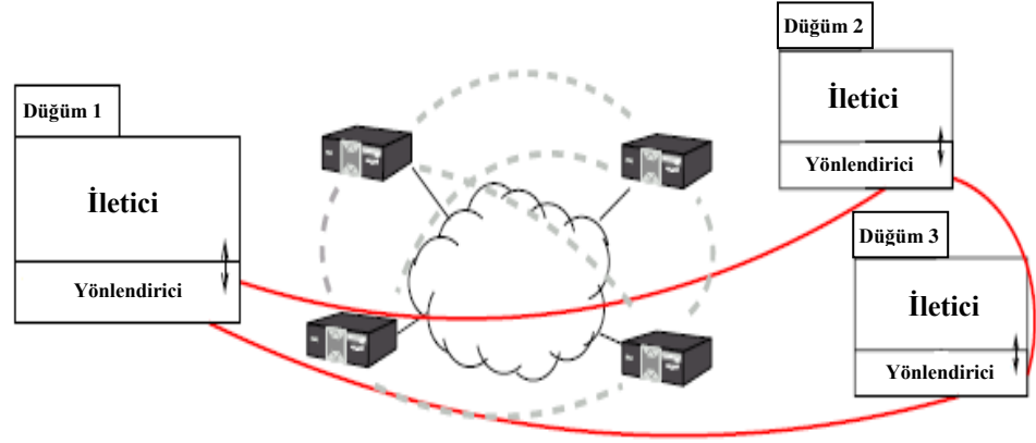
Şekil 2.8. Dirençli üstüne bindirmeli ağ mimarisinde yönlendirme işlemi (Andersen et al., 2001 – Figure 3).
