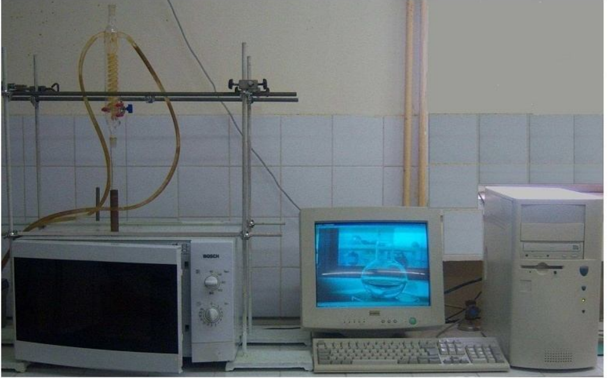
Şekil 5.1. Sentez çalışmalarının gerçekleştirildiği bir takım değişiklikler yapılmış (modifiye edilmiş) ev tipi mikrodalga fırın.
