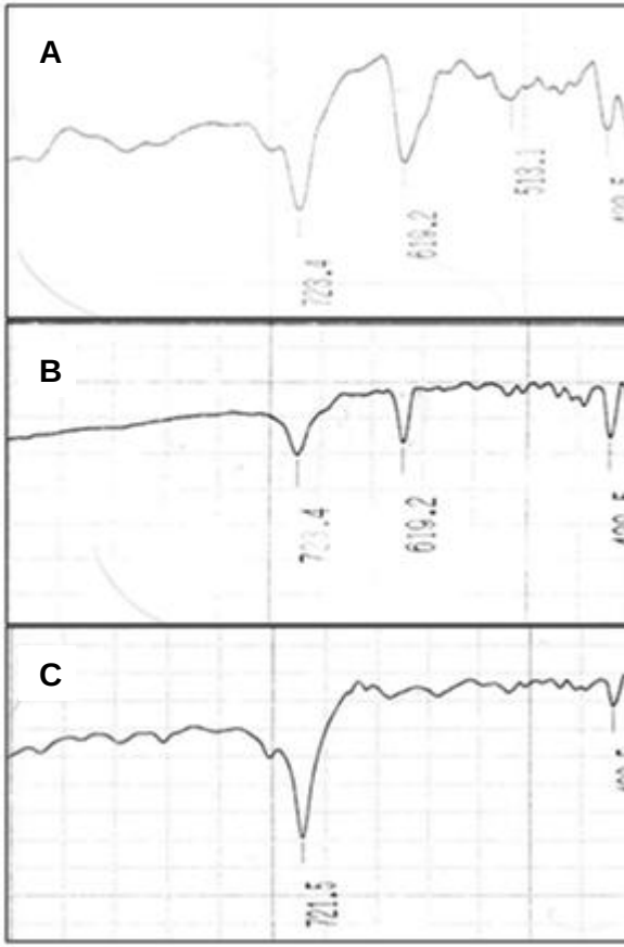
Şekil 4.1. A) Au/DT oranı 1/40 oranında sentezlenen partiküllerin, B) Au/DT oranı 1/15 oranında sentezlenen partiküllerin ve C) FTIR Au/DT oranı 3/1 olarak sentezlenen partiküllerin FTIR grafikleri verilmiştir.
