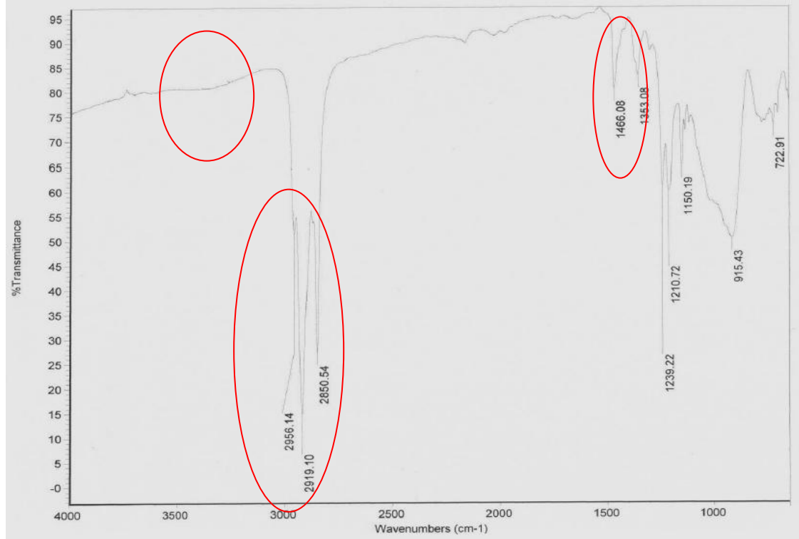
Şekil 2. 10/1 DT/MUD kaplı partiküllerin FTIR ile yapılan ölçümü
