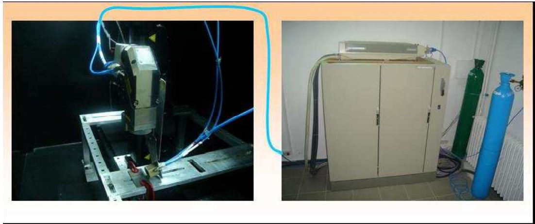
Şekil 4.1: Deneysel çalışmalarda kullanılan Nd:YAG lazer sistemi: güç ünitesi, lazer kovuğu ve odaklama ünitesi (LATARUM).
