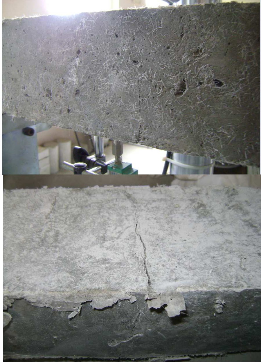
Şekil 5.9 Kiriş numunelerde eğilme testi sonucunda oluşmuş çatlaklar
