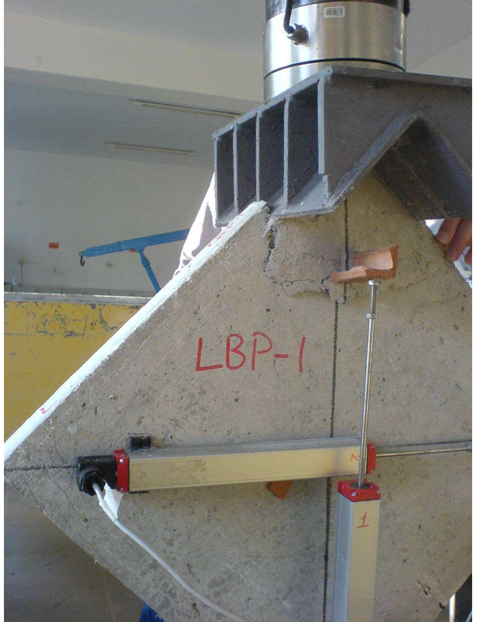
Şekil 5.16 Panelde oluşan ezilme
