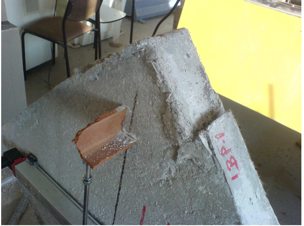
Şekil 5.19 Panelde oluşan ezilme
