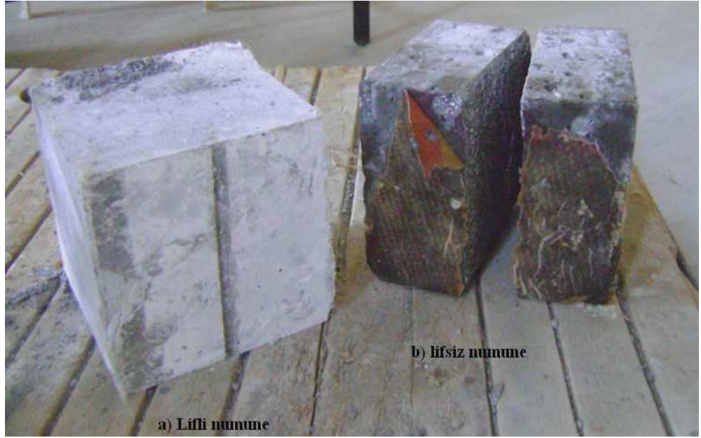
Şekil 5.7 Lifli ve lifsiz küp numunelerinin yarma deneyi altındaki davranışı
