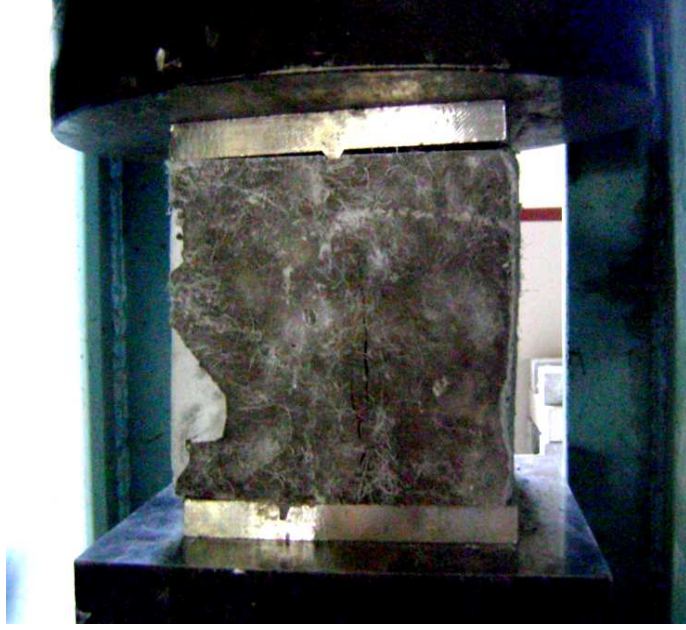
Şekil 5.6 Yarma deneyi sonucunda oluşan çatlaklar
