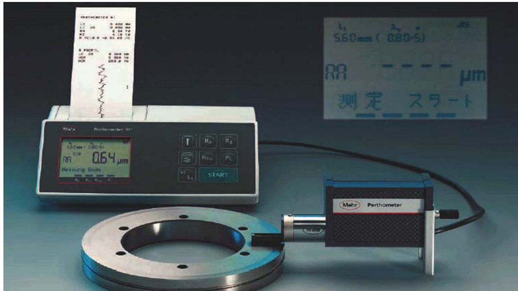
Şekil IV.5. Yüzey pürüzlülüğü ölçüm cihazı
