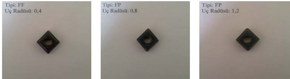
Şekil IV.7. Deneyde kullanılan kesici uçlar
