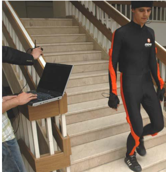
Şekil 24. Merdiven İniş / Çıkış Hareketine Ait Hareket Verilerinin Toplanması. 25
