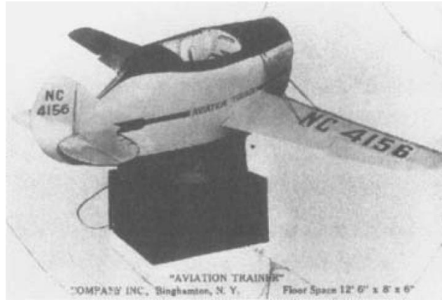
Şekil 3. 1929 Yılında Edward Link Tarafından Geliştirilen Penguin İsimli Uçuş Eğitim Simülatörü. 4
