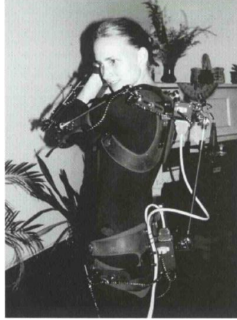
Şekil 18. Gypsy 2 Hareket Yakalama Sisteminde Kullanılan Mekanik İzleyiciler. 20
