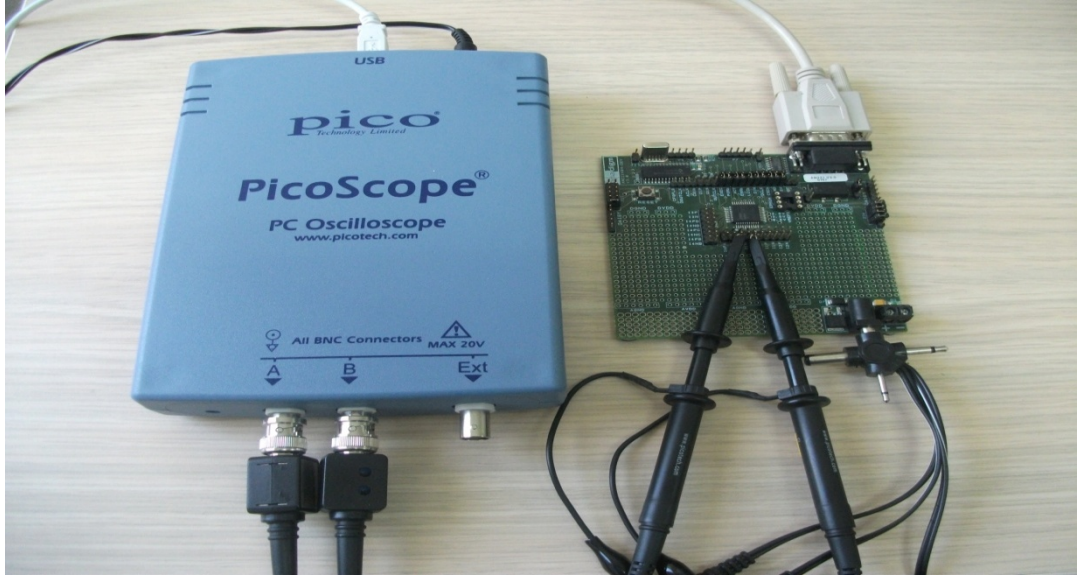
Şekil 4.2. FPAA-Tabanlı Gerçekleştirimin Deneysel Kurulumu. Bu Kurulumda Anadigm Firmasının AN221E04 Tipi FPAA [6] Kullanılmıştır.
