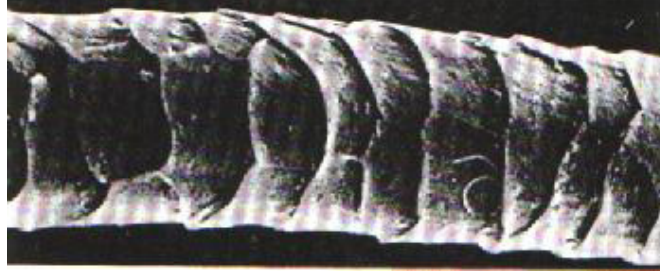
Fotoğraf 2.2 Elektron mikroskopunda yün elyafının büyütülmüş görünüşü, yüzey yapısı ve yüzeyi oluşturan görünüşü [10].
