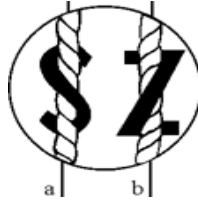
Şekil 2.4 İplikte büküm yönünün gösterimi
