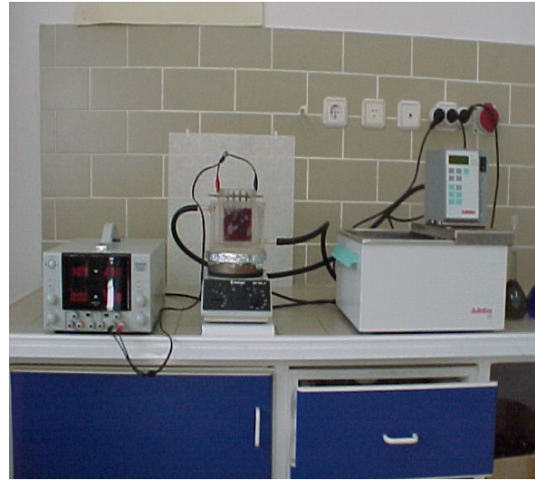
Şekil 4.1. Kesikli EC proses çalışmalarında kullanılan deney düzeneği
