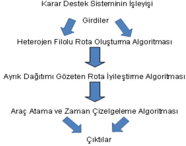
Şekil 5.5 : Karar destek sisteminin işleyişi
