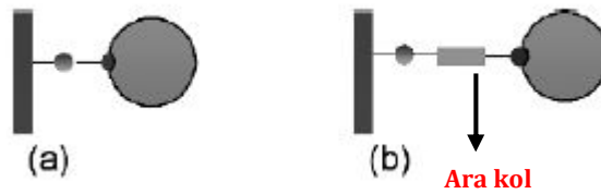
Şekil 1.5 Kovalent bağlı enzimlerin ara kolsuz (a) ve ara kol (b) kullanılarak yapılan immobilizasyonu.
