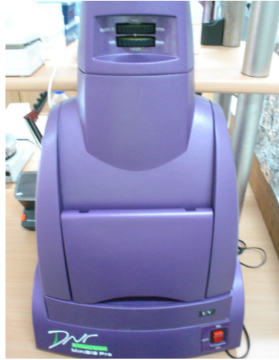
Şekil 3.4. PCR sonuçlarının değerlendirilmesinde kullanılan DNR jel görüntüleme sistemi.
