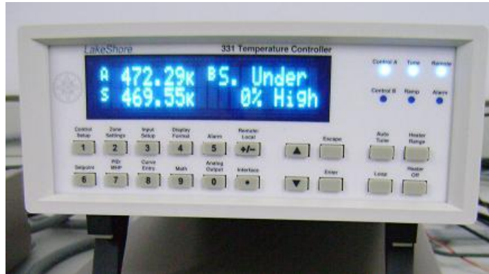
Şekil 3.5. Sıcaklık kontrolünü sağlayan LakeShore 331 Temperature Controller cihazı
