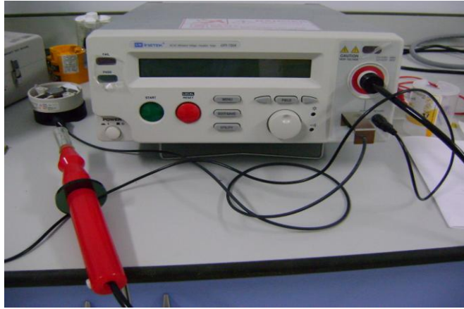
Şekil 3.2. Delinme gerilimini ölçmek için kullanılan GW-Instek GPI-735A marka cihaz
