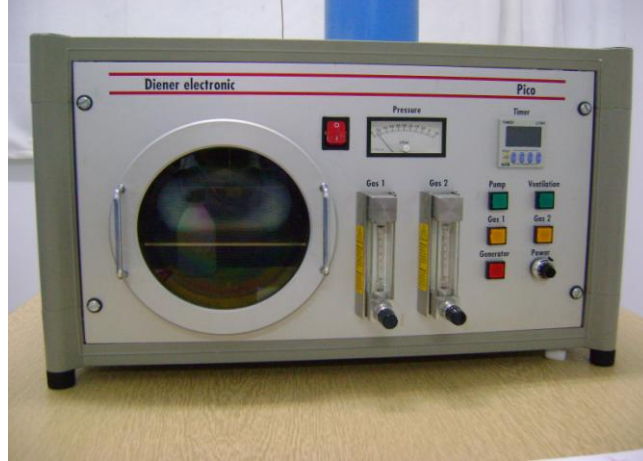
Şekil 3.7. PEKBÇ (PECVD) amacıyla kullanılan Diener Electronic-Pico marka plazma cihazı.
