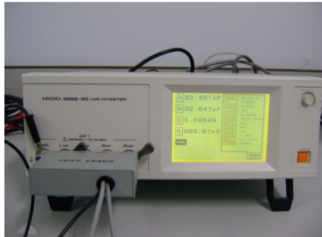
Şekil 3.3. C, D ve G'yi ölçmek için kullanılan Hioki 3522-50 marka LCRmetre
