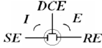
Şekil 2.13. Polarografide kullanılan üç elektrotlu sistem (DCE damlayan cıva elektrot, RE referans elektrot, SE sekonder elektrot)
