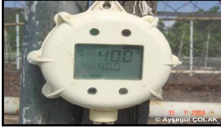
Şekil 3.8. Sera toprağının sıcaklığını ölçen hobo aleti
