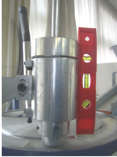
Şekil 4.16 Ucun ve ağırlığın çelik tabla yüzeyindeki konumu.
