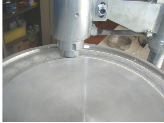
Şekil 4.19 Aşındırıcı malzemenin disk tabla üzerindeki durumu.
