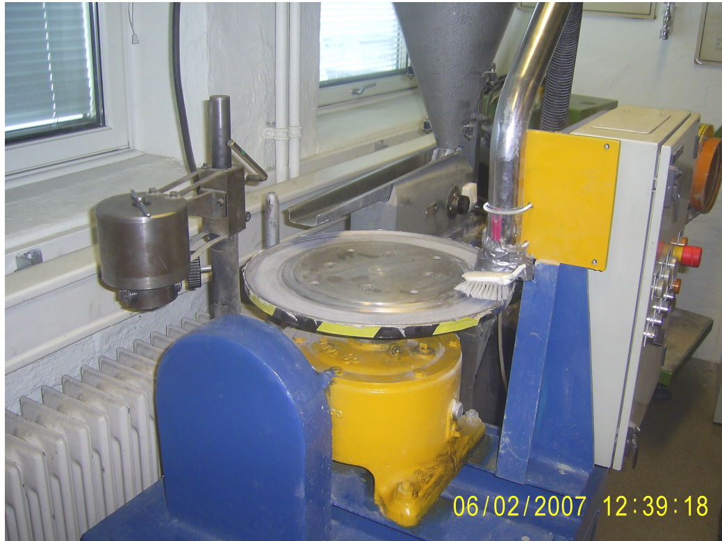
Şekil 4.10 Norveç'teki orijinal Norveç aşınma deney aleti.
