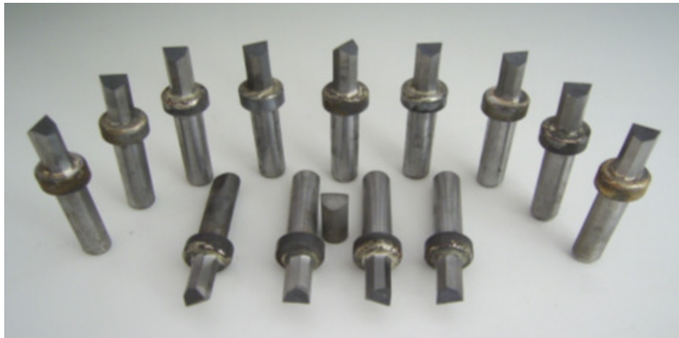
Şekil 4.6 SJ deneyinde kullanılan özel uçlar ile geometrisi.
